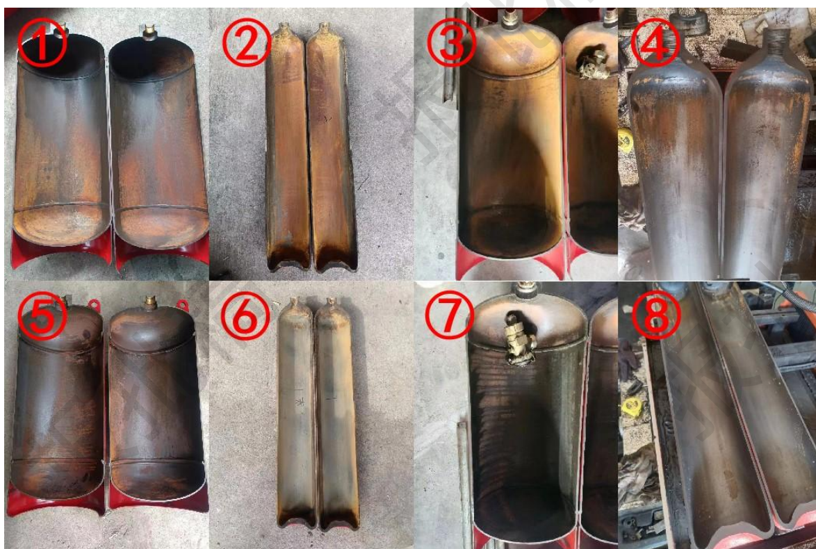
图 1 全氟己酮灭火剂长期储存后钢瓶内部腐蚀情况
